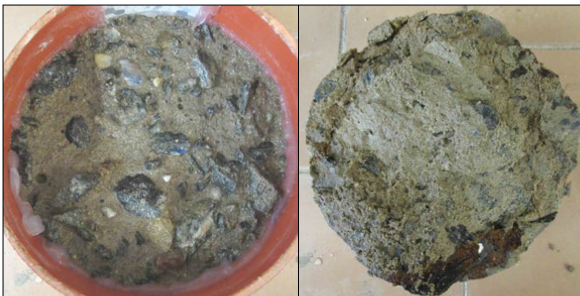
Foto 6: Pohled na líc a „dno“ vzorku V8 – po CH.R.L. - metoda C – 50 cyklů
