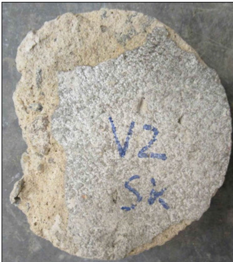
Foto 1: Pohled na líc vývrtnu V2 před zkouškou
