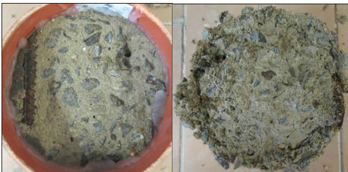
Foto 8: Pohled na líc a „dno“ vzorku V10 – po CH.R.L. - metoda C – 50 cyklů
