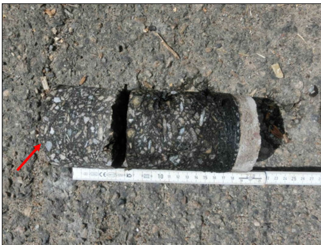
Foto 4: Pohled na výnos z vrtu V11 pro stanovení skladby vozovky. Šipkou vyznačen horní líc vozovky.
