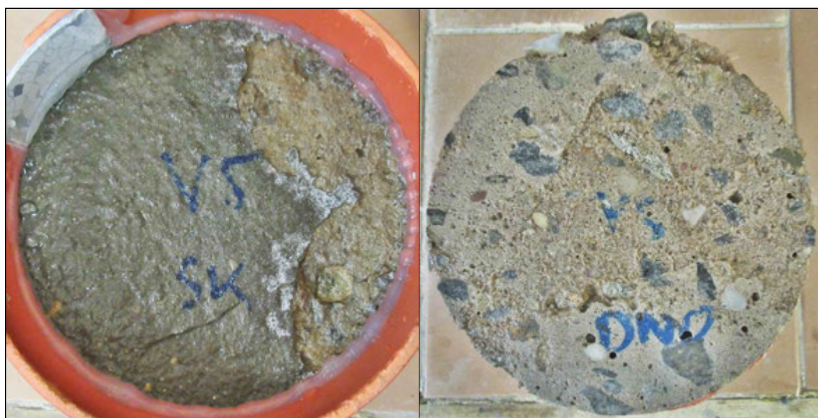
Foto 4: Pohled na líc a „dno“ vzorku V5 – po CH.R.L. - metoda C – 75 cyklů
