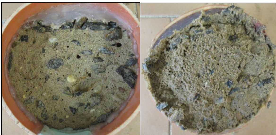
Foto 2: Pohled na líc a „dno“ vzorku V2 – po CH.R.L. - metoda C – 50 cyklů
